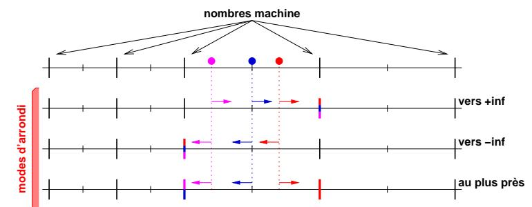
Propriété d'**arrondi correct** : soient  $a$  et  $b$  deux nombres machine,  $\odot$  une des opérations  $(+, -, \times, \div)$  et  $\diamond$  le mode d'arrondi choisi (parmi les 4 modes IEEE). Le résultat fourni lors du calcul de  $(a \odot b)$  doit être  $\diamond(a \odot_{th} b)$ .
