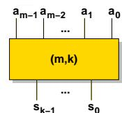
La cellule demi-additionneur (*half-adder* ou HA) est un compteur (2,2) tandis que la cellule d'addition complète (*full-adder* ou FA) est un compteur (3,2). Ces deux portes sont largement utilisées dans les opérateurs arithmétiques.
