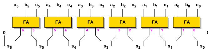
Plus généralement, un arbre *carry-save* à  $h$  niveaux permet de réduire au plus  $n(h)$  entrées non-redondantes selon le tableau ci-dessous. On a  $n(h) = \lfloor 3n(h-1)/2 \rfloor$  et  $n(0) = 2$ .
